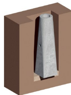
Figur 6 - Hullet til fundamentet graves.
